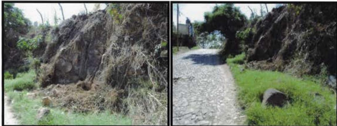
**Figura 66. Obsérvese en parte superior de la imagen la poca vegetación en la ladera, así como también, las rocas que se exhiben debido al proceso de erosión de las cuales, son susceptibles a caídas.**
